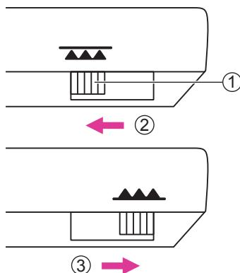
Чтобы отключить подачу ткани, передвиньте переключатель влево. Чтобы включить транспортер - передвиньте переключатель вправо. Зубцы поднимутся после того, как машина сделает полный оборот маховика.
