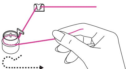
3. Оберните нить вокруг дисков натяжения один раз против часовой стрелки.
