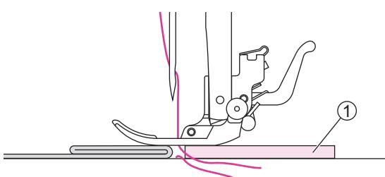
Если пользоватьсяся кнопкой по какой-то причине неудобно, можно подложить под заднюю часть лапки картонку подходящей толщины или специальную подъёмную пластину.
