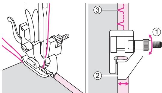
Положите ткань под лапку. Поворачивайте маховик на себя до тех пор, пока игла не передвинется в крайнее левое положение. В этом положении игла должна захватывать буквально одну ниточку из складки ткани. Если это не так, подстройте ширину строчки. Отрегулируйте положение направителя на лапке так, чтобы он едва касался складки.
