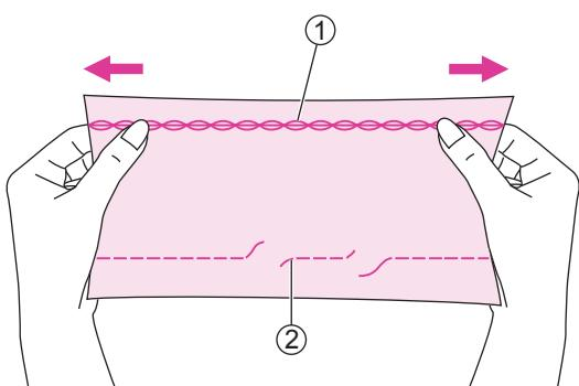
Строчка хорошо подходит для сшивания трикотажа и других растяжимых тканей средней плотности, а также для прочных тканей, вроде джинсы.
