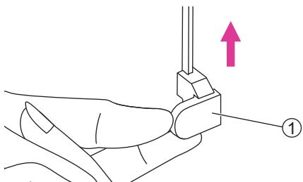
Поднимите прижимную лапку и обрежьте нить. Чтобы прошить еще раз поверх той же петли, поднимите лапку, и она вернется в исходное положение.
