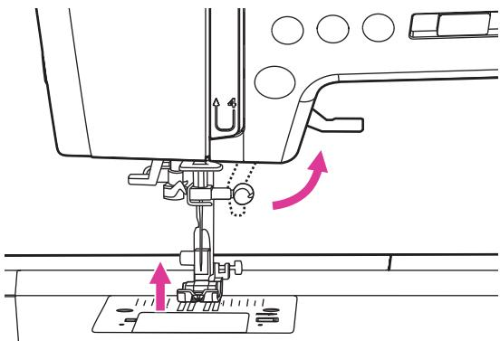
Рычаг подъема лапки поднимает и опускает прижимную лапку.
