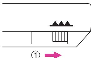
Передвиньте рычаг отключения зубцов транспортера, чтобы отключить подачу ткани.
