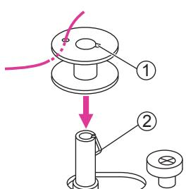
4. Проденьте нить сквозь отверстие в шпульке изнутри наружу и установите шпульку на ось моталки так, чтобы пружина попала в прорезь.
