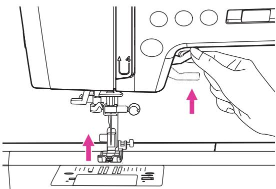
Чтобы разместить под лапкой толстый или многослойный материал, прижимную лапку можно поднять выше обычного положения.
