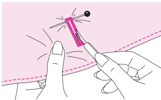
Прорезая середину петли, будьте осторожны, чтобы не разрезать нити закрепки. Воткните в закрепку булавку, чтобы избежать разреза закрепки и ткани.
