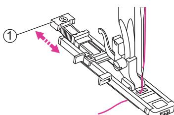
Выдвиньте держатель пуговиц и установите желаемый размер штопки. Установите ширину строчки и длину стежка в соответствии с желаемой шириной и плотностью.
