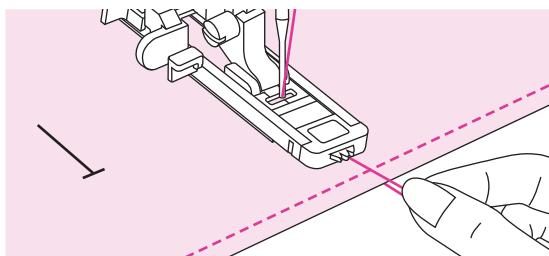
Потяните за рычаг измерения петли вниз до упора и расположите его между выступами лапки.
