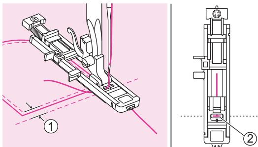
Выдвиньте пластину держателя пуговицы и установите желаемую длину закрепки.
