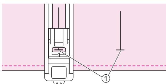
Расположите ткань под лапкой так, чтобы в центре отверстия лапки была видна отметка начала петли.
