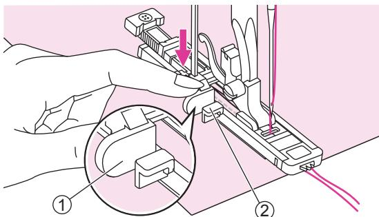
Опустите рычаг механизма обметывания петель вниз до упора и расположите его позади скобы на лапке для петель.
