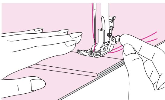
Когда вы прошьете до начала толстого места, опустите иглу в ткань и поднимите лапку. Нажмите на переднюю часть лапки, нажмите черную кнопку, опустите лапку и начните шить.
