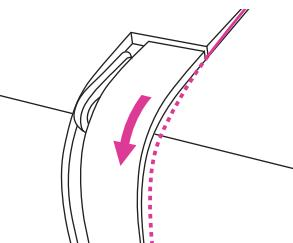
4. Заправьте нить в блок натяжения так, чтобы нить попала между серебристыми дисками натяжения.
