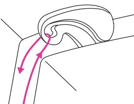
6. В верхней части прорези важно заправить нить в нитепрятгиватель. Если нитепрятгиватель утоплен в прорези, поверните маховик на себя, пока нитепрятгиватель не придет в верхнее положение. После нитепрятгивателя опустите нить обратно в прорезь.
