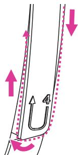
5. Пропустите нить ниже в прорезь, а затем поднимите наверх.
